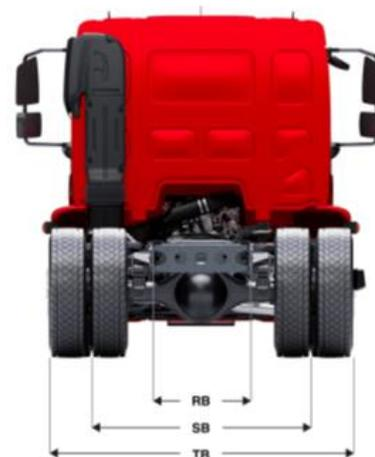
Hauteur de faux-châssis minimale : 97 mm avec pneumatiques 245/70R17,5 et longerons 210 mm
