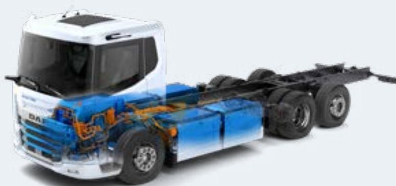
Les nouveaux DAF XD et XF sont disponibles avec une large gamme de moteurs électriques et de batteries offrant une autonomie tout électrique de 200 à plus de 500 kilomètres, ce qui permet à DAF de proposer une solution pour chaque application 'zéro émission'.
